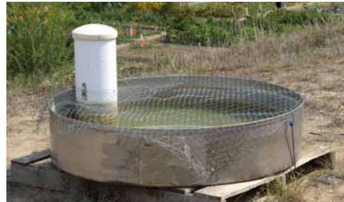
Ilustración 4.5: Tanque para medir la evaporación del agua.
