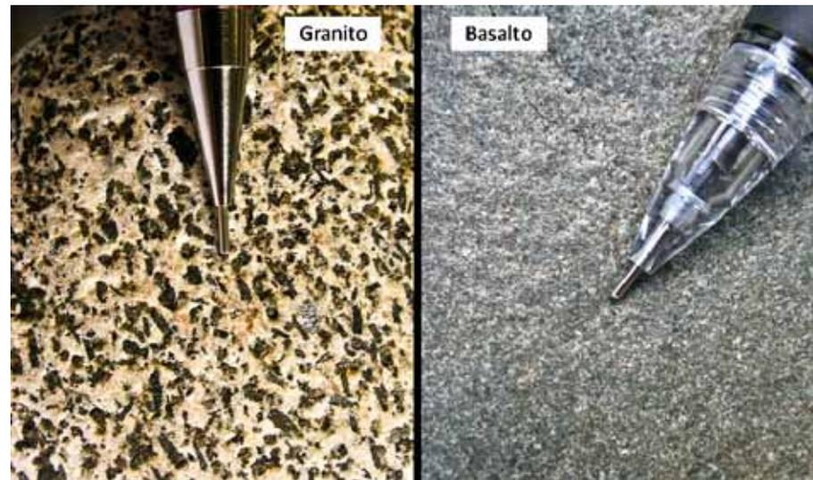
Ilustración 2.3: Comparación de basalto y granito. En el granito es fácilmente visible la estructura cristalina, contrario al basalto.
