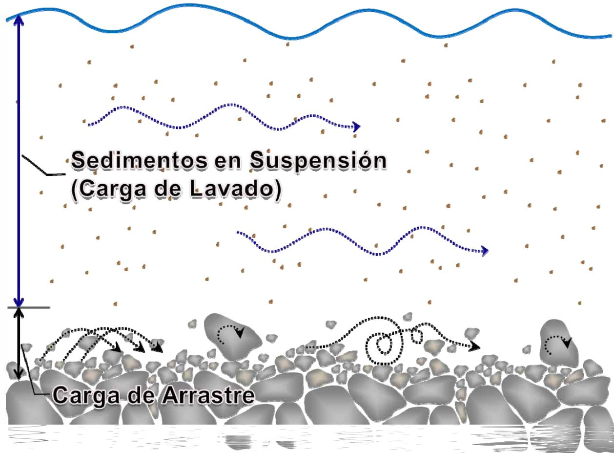
Ilustración 5.5: Clasificación de sedimentos por modo de transporte.
