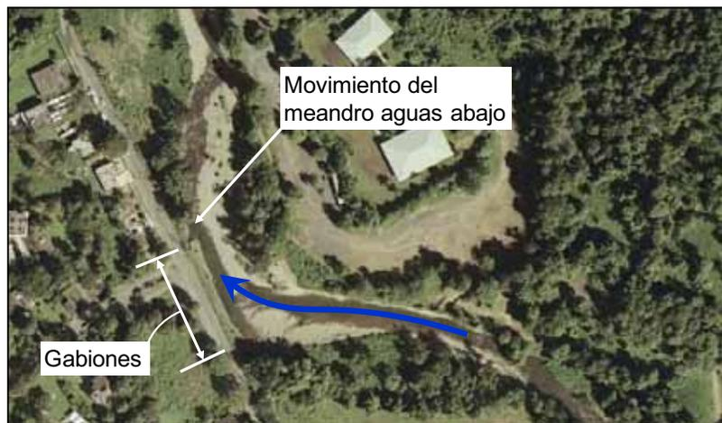
Ilustración 10.11: Localización del talud erosionado.
